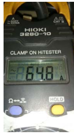
2. 原台製泵浦所測的電流值 64.8A
