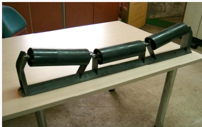
三截式PVC支撐滾輪卡榫 式設計拆卸清除積垢容易
