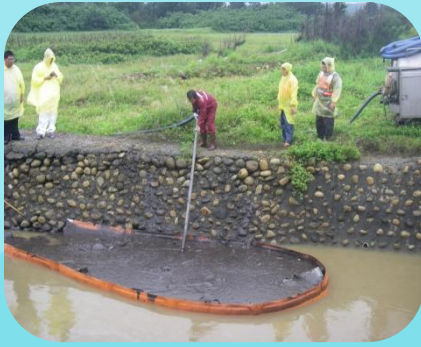
扁平型固體填充式攔油索 Fence Boom (Flat)
