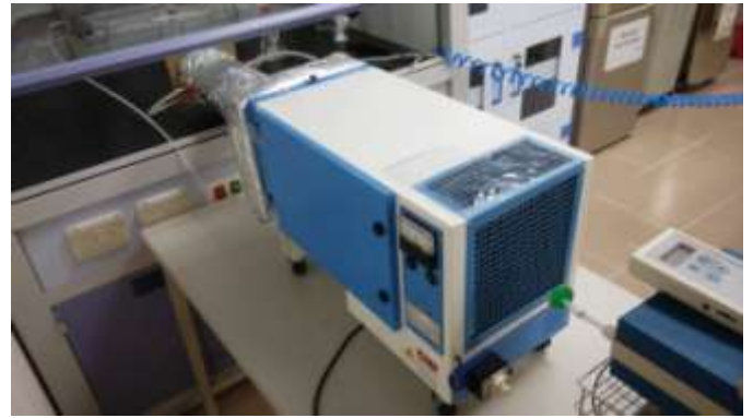
圖 2: 工業用靜電式除煙集塵空氣清淨機(含靜電模組, 高機能碳濾網, 高分子冷觸媒分子篩濾網)
