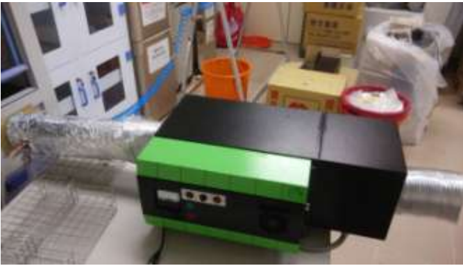
圖 1: 空調用靜電式除煙集塵空氣清淨機(含靜電模組, 高分子冷觸媒分子篩濾網)
