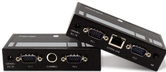
這套網線型單向電腦廣播教學系統，採用 CAT5 UTP 雙絞線影音傳輸的最新技術，相較於以往使用 VGA 線串聯的傳統方式，網線型單向電腦廣播教學系統，以並聯點對點的影音傳輸式，每一點最遠均可達 200 公尺，廣播時影音效果完美不打折；且兩位學生可以共用一台收盒，在線路配置的部分相當簡潔並且經濟。
