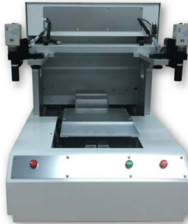
LT2500 觸控面板( Touch Sensor)自動對位測試機主要功能是提供 Touch Sensor 測試時自動對位測試使用，使用者可以將 Sensor IC 設計公司提供的 Touch Sensor 測試工具，整合到 LT2500，LT2500 會利用 CCD 自動對位方式，快速且精準將 Sensor IC 設計公司測試工具的 FPCB 或 Pogo Pin 自動對位到 Touch Sensor 的 Bonding Pad，再進行測試。LT2500 也可以整合 LT2000 Touch Sensor 電測機，自動量測 Touch Sensor 的 Open、Short、線電阻、絕緣電阻及節點電容，LT2500 Touch Sensor 自動對位動作時間(Tack Time)只需 3 Sec.。
