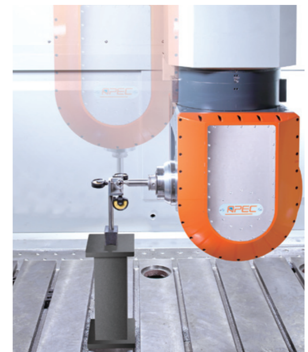
3D 檢測 TCPM，行程範圍內 C ± 180° / B ± 90°，工作台中心幾何精度
